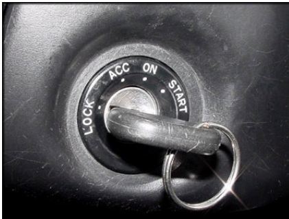
سوئیچ استارت و محل قرارگیری آن در سمت راست غربیلک فرمان
